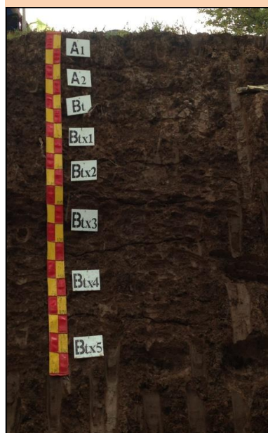
ภาพที่ 21 สภาพแวดล้อมของพื้นที่ และภาพหน้าตัดของดินที่พบชั้นดานเปราะ อำเภอลำสนธิ จังหวัดลพบุรี
