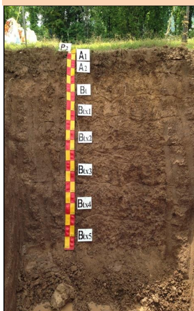
ภาพที่ 21 สภาพแวดล้อมของพื้นที่ และภาพหน้าตัดของดินที่พบชั้นดานเปราะ อำเภอลำสนธิ จังหวัดลพบุรี
